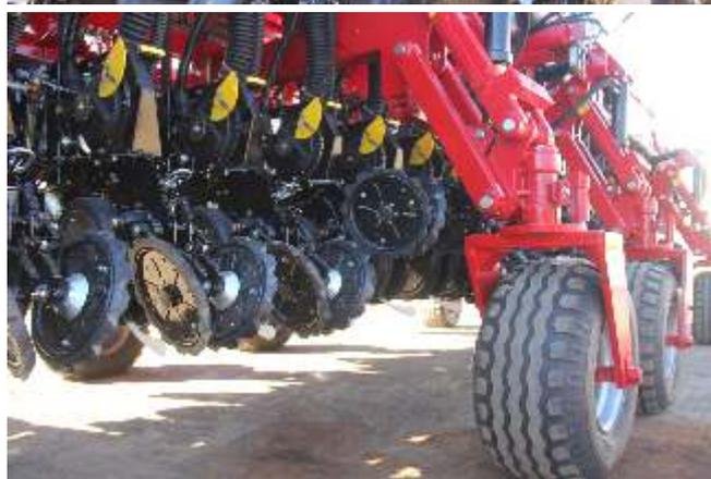
La DX 2142 posee dosificación mecánica o neumática, en tanto que la transmisión puede ser mecánica, eléctrica o hidráulica (de acuerdo a criterio del productor)
