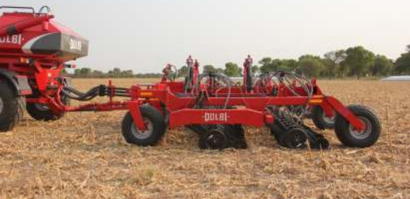
La sembradora DOLBI Air Drill AD3000 trabaja con un carro tolva de doble compartimiento, de 11.800 litros de capacidad.
